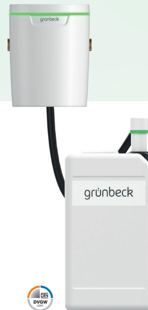
La serie **exaliQ:SC** è costituita da lance di aspirazione con un serbatoio di dosaggio posizionato separatamente sul pavimento accanto all'impianto. La soluzione minerale viene aspirata dal serbatoio mediante una lancia di aspirazione e dosata nella tubazione attraverso la pompa exaliQ.
